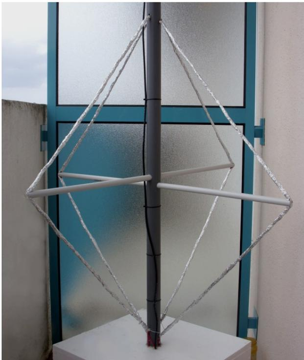
La photo est l'antenne de la station LR La Riche (France), cette antenne est une antenne HQG qui contient 50 spires de fil de cuivre 0,35mm, elle est très sensible, et peut capter des impacts jusqu'aux Etats-Unis la nuit.
